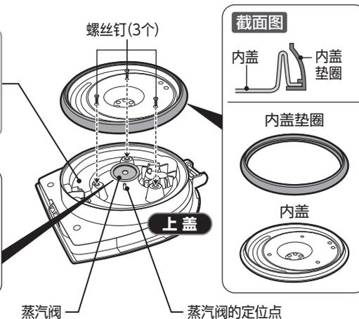
内盖垫圈出现变硬、变形、变白等损耗状况时，当倾斜或不慎弄翻时，上盖与本体之间的缝隙间可能流出热水而导致烫伤。也可能因蒸汽漏出导致烫伤或故障。换内盖垫圈后还是蒸汽泄漏或热水溢出时，可能有其他零配件的损坏，请咨询本公司的客服窗口。
