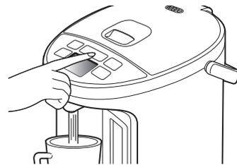
注水结束约10秒后，锁定解除指示灯灭，便启动“自动出水锁定”功能。
